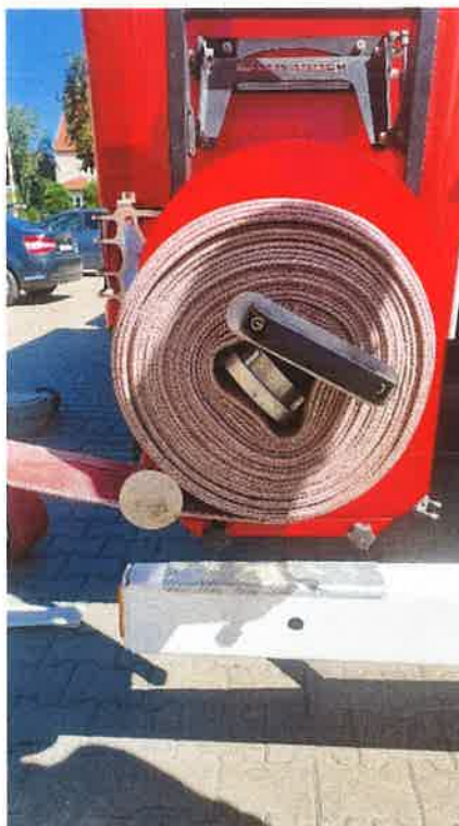
Fot. 4. Zwijanie węża W75 w pojedynczy krąg - zwijacz zamocowany do drabinki pojazdu pożarniczego Źródło: CNBOP-PIB.
