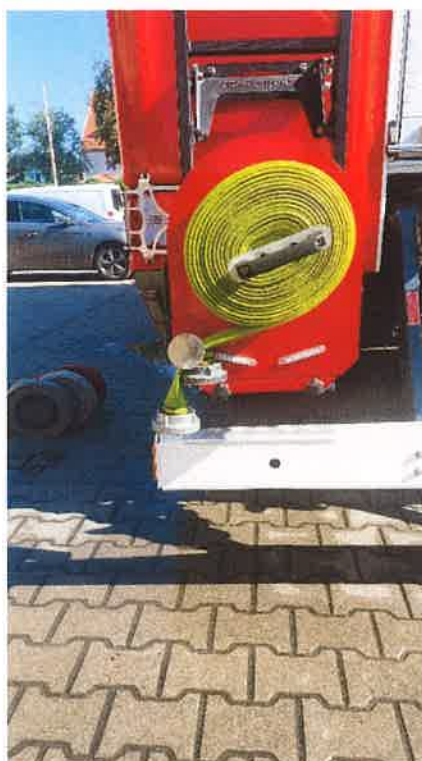
Fot. 5. Zwijanie mokrego węża W42 - zwijacz zamocowany do drabinki pojazdu pożarniczego Źródło: CNBOP-PIB.
