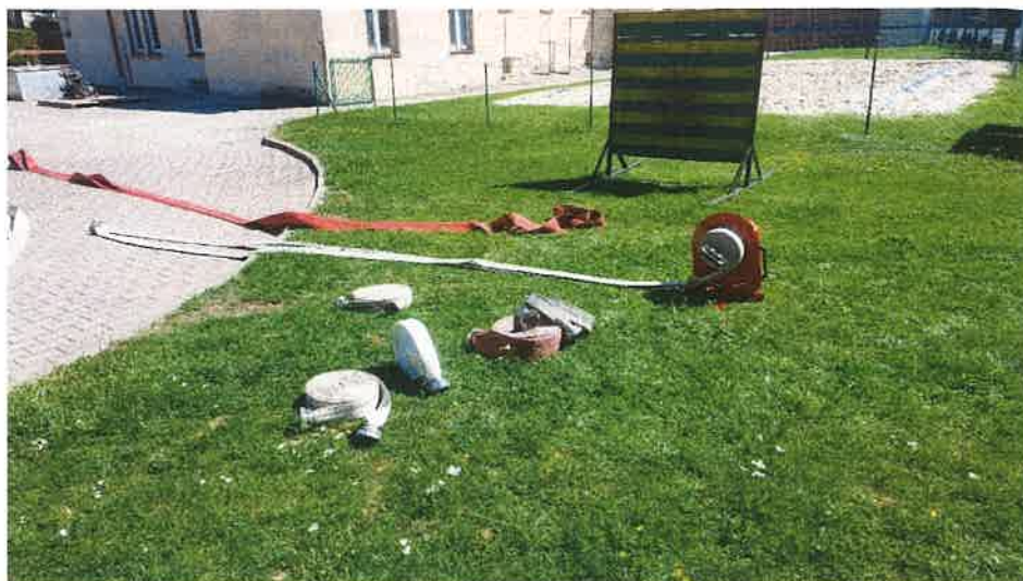
Fot. 2. Zwijanie węża W52 - zwijacz wolnostojący Źródło: CNBOP-PIB.
