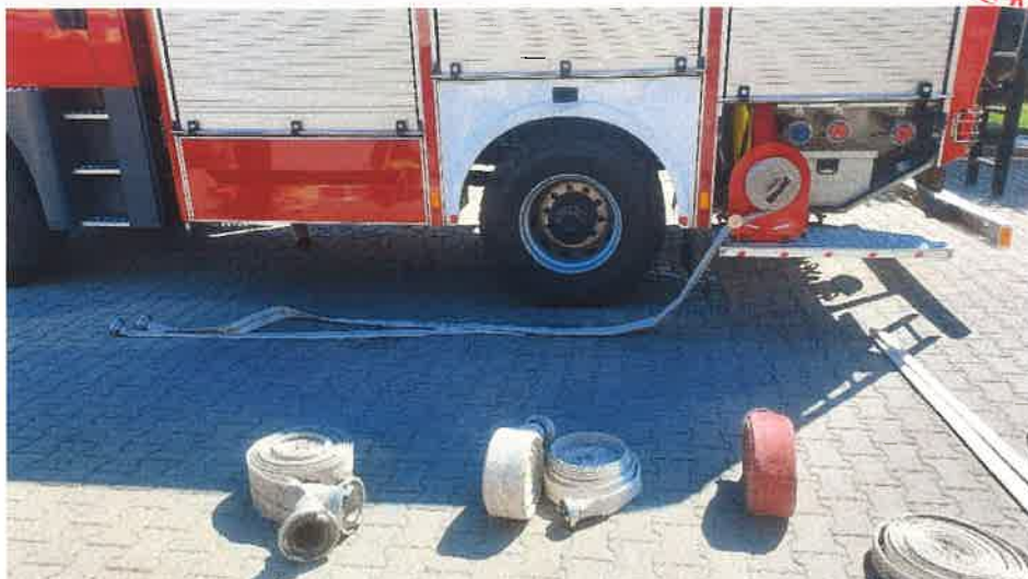
Fot. 6. Zwijanie węża W52 - zwijacz ustawiony na podeście pojazdu pożarniczego Źródło: CNBOP-PIB.
