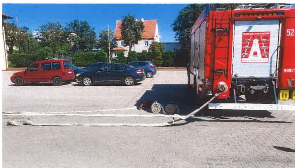
Fot. 3. Zwijanie węża W110 - zwijacz zamocowany do drabinki pojazdu pożarniczego Źródło: CNBOP-PIB.
